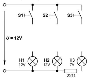
Vervollständigen Sie die abgebildete Schaltung, so daß durch den Einbau von Siliziumdioden (1N4007) folgende Funktionen erfüllt werden:
