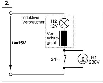
Induktive Verbraucher (Schütze, Motoren) werden in der Leistungselektronik über Halbleiter (Transistoren, Thyristoren) geschaltet. Die hohe Selbstinduktionsspannung (angezeigt durch H1), die über dem abschaltenden Halbleiter (simuliert durch S1) entsteht, kann zur Zerstörung des Halbleiterbauelements führen.
