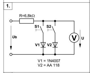
a) Messen Sie für die beiden unterschiedlichen Betriebsspannungen die jeweils in der Tabelle geforderten Spannungswerte.
