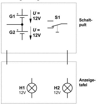
Das Schaltpult ist über eine <u>zweiadrige</u> <u>Anschlussleitung</u> mit der Anzeigetafel verbunden.
